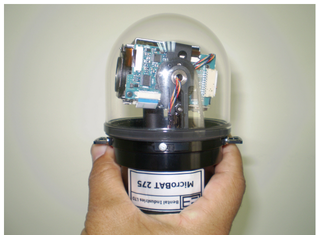
Bental MicroBAT 275 stabilisiertes Kamerasystem
